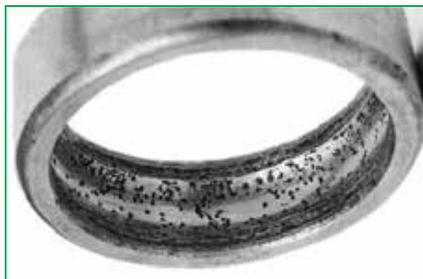
Fig. 8 Corrosione, cuscinetti inutilizzati
