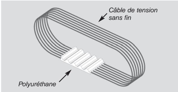
Ne possédant ni raccord ni soudure de jonction, la section des courroies ELA-flex SD™ ne comporte pas de point faible. Par conséquent, les courroies synchrones ELA-flex SD™ sont idéales pour les applications de transmission de puissance à vitesse élevée et de convoyage de lourdes charges.
