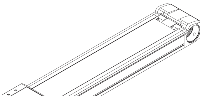
Fig. 7.18 : Démontage/montage du dispositif de serrage de la bande de recouvrement pour HT-B
