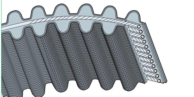
Les courroies synchrones TOP DRIVE® HTD DUAL peuvent être utilisées dans une large gamme d'applications, où une ou plusieurs poulies sont entraînées par une courroie. Les dents intérieures et extérieures sont identiques et se trouvent directement en correspondance les unes avec les autres. Elles peuvent être utilisées avec des poulies synchrones standard HTD.
